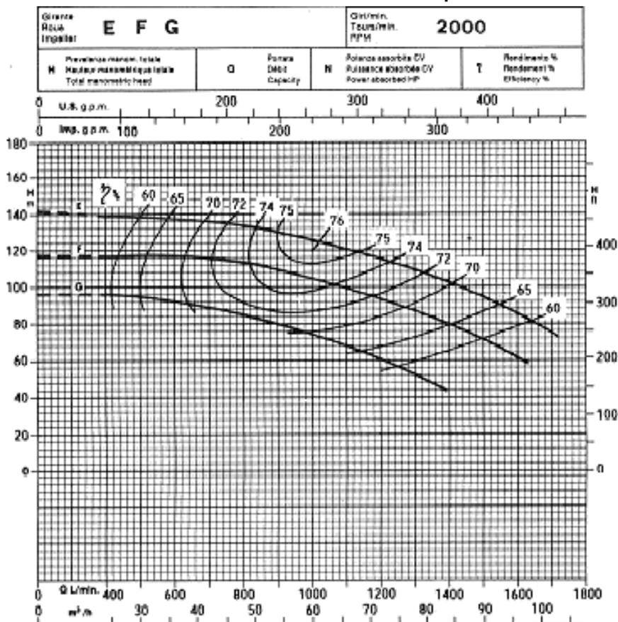
Liquido di prova: Acqua — massa vol. 1000kg/mc
