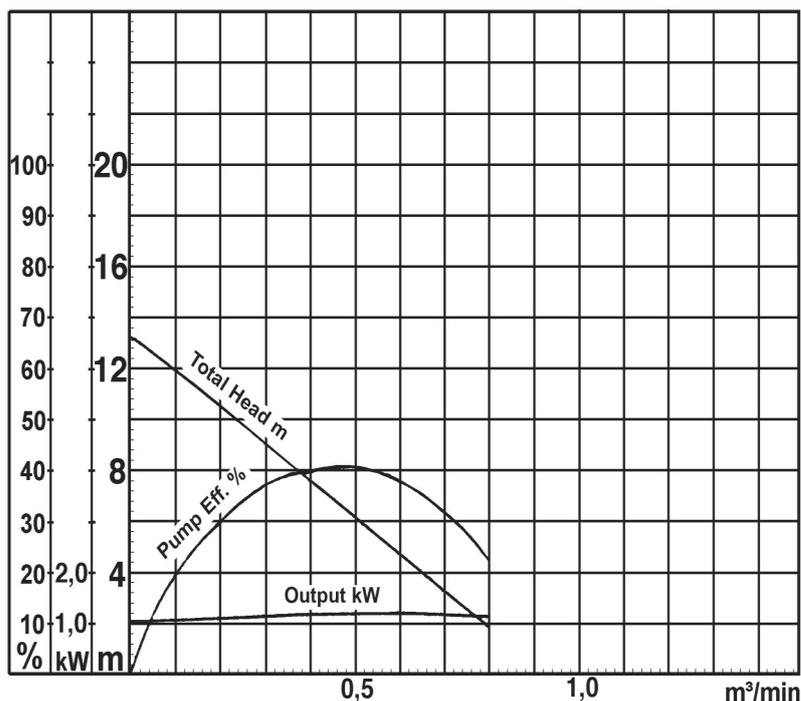
Liquido di prova: Acqua — massa vol. 1000kg/mc
