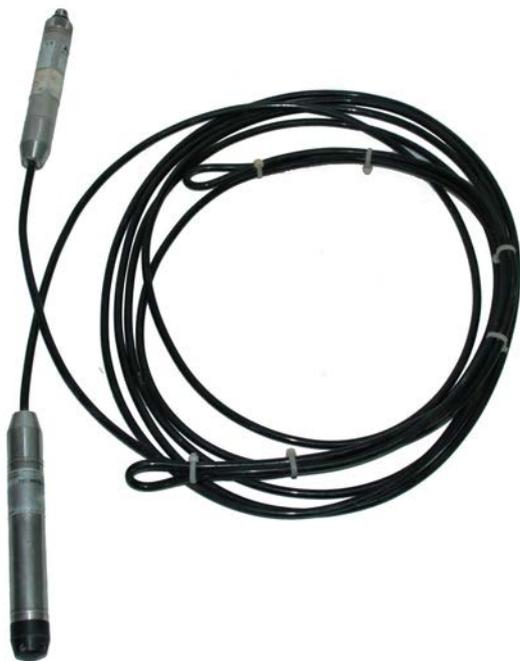
Sonda multiparametrica con Datalogger
