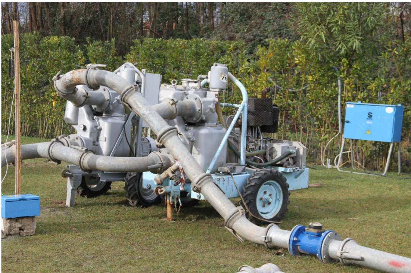
Disposizione delle POMPE di un impianto wellpoint Pompa Elettrica (a sin.) e Motopompa Diesel Automatica di Emergenza (a ds.)
